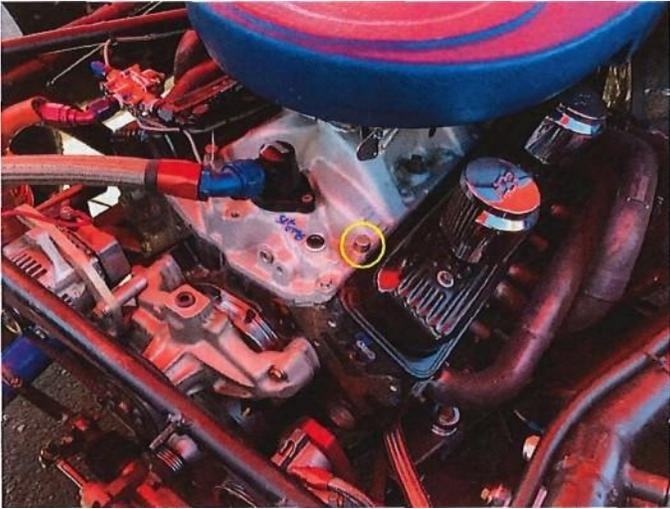
SEAL ON INTAKE MANIFOLD
